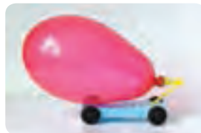
خودروی بادکنکی (حرکت از طریق نیروی باد)
