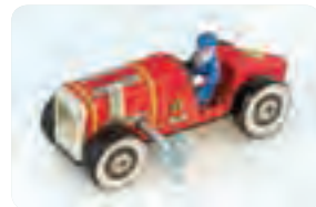
خودروی کوکی (حرکت از طریق نیروی فنر)
